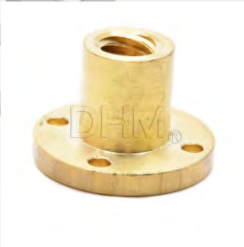
La confezione contiene: 1 x Chiocciola ottone Ø16 mm pitch 3 mm 1 principio Chiocciola per vite trapezia, diametro 16 mm. Serve per la realizzazione di movimentazioni di precisione nelle stampanti 3d e nelle piccole CNC La chiocciola è adatta a barre trapezie TR16x3 (passo 3 con 1 principio, quindi ogni giro si muove di 3 mm).
