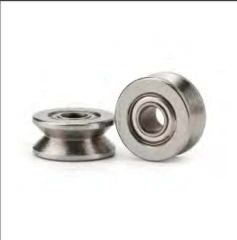
La confezione contiene: 1 x Cuscinetto V-groove 624ZZ Cuscinetto 624ZZ V-groove. Diametro interno: 4 mm Diametro esterno: 13 mm Spessore: 6 mm Cuscinetto a sfere single row deep groove. Ha 2 coperture metalliche per evitare che lo sporco vada a intaccare le sfere. I cuscinetti sono pre-lubrificati.
